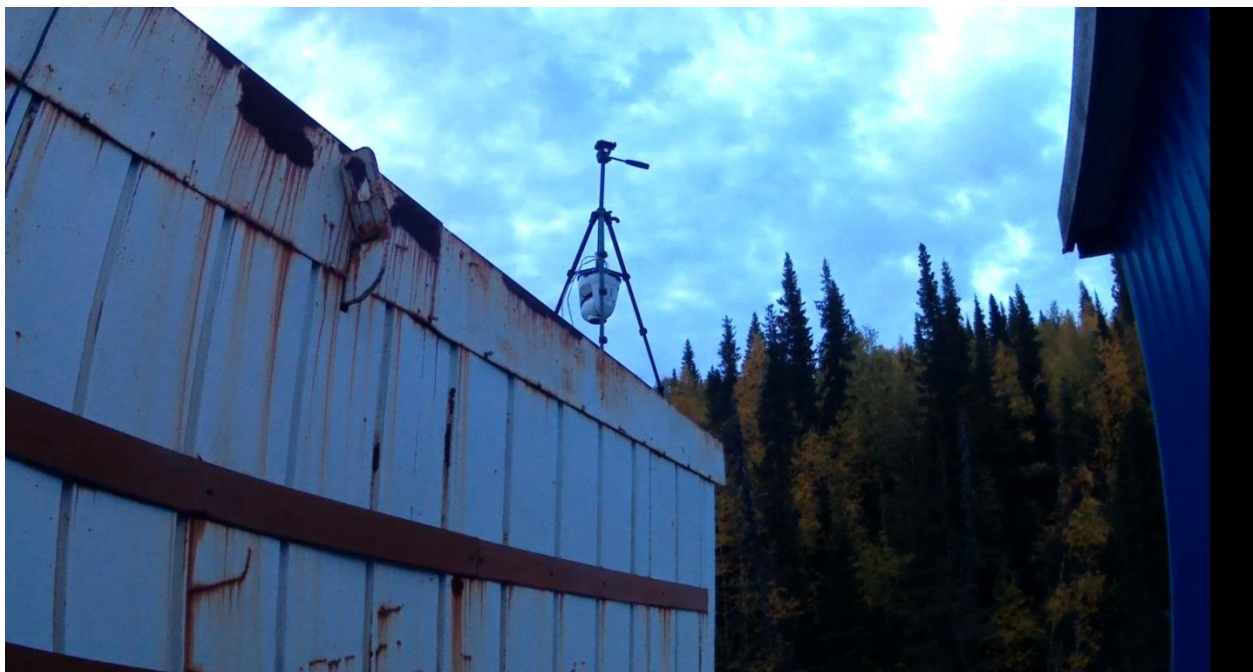
Рис. 8 Тепловизор, установленный на крыше балка (фото Г. Куртова).
